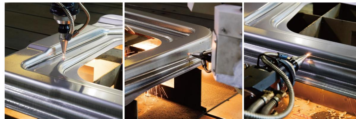
建設機械部品を加工中の三次元レーザー加工機。
